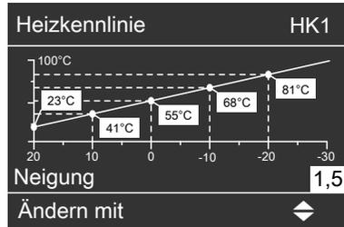
In Abhängigkeit von verschiedenen Außentemperaturen (dargestellt auf der waagerechten Achse) werden die zugeordneten Vorlauftemperatur-Sollwerte für den Heizkreis weiß hinterlegt angegeben.
