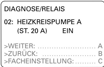
Dieser Test ermöglicht die Prüfung der Schaltzustände verschiedener Relais, die der Ansteuerung unterschiedlicher Anlagenkomponenten dienen. Nach Öffnen der Klappe der Bedieneinheit folgenden Weg durch das Menü gehen:
