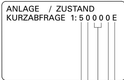
Einstellungen und Schaltzustände der Dekamatik können über eine Kurzabfrage geprüft werden.
