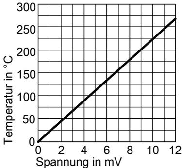
Kennlinie des Thermopaars NiCr / Ni (Typ K) bei einer Vergleichsstellentemperatur von 0 °C
