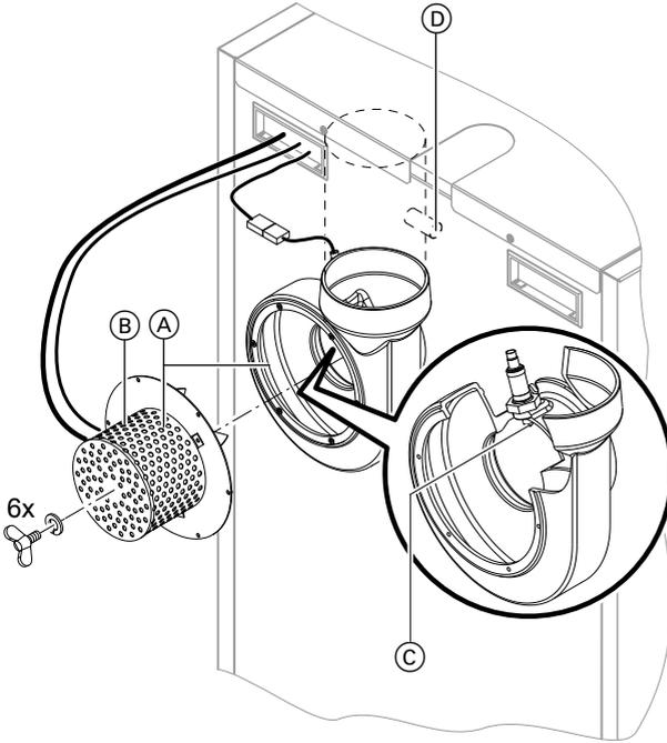
1. Flügelschrauben am Abgasgebläse (A) lösen und Motor (B) mit Gebläse-
