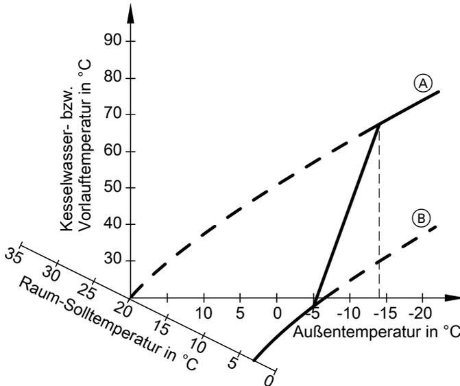
(A) Heizkennlinie für Betrieb mit normaler Raumtemperatur
