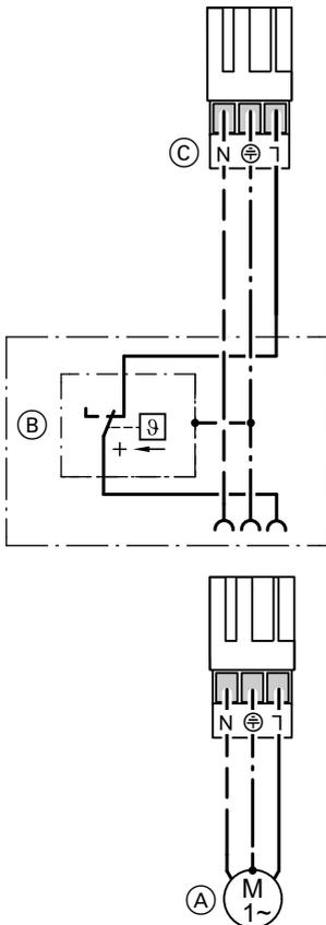
Elektromechanischer Temperaturwächter nach dem Flüssigkeits-Ausdehnungsprinzip.
